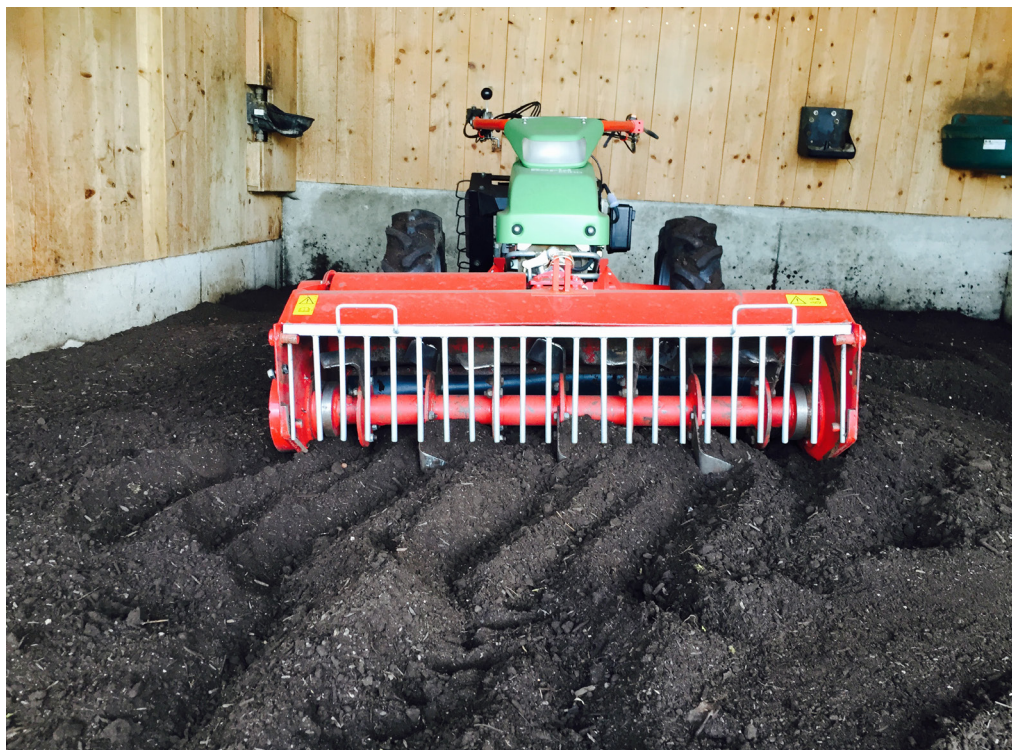
Franz von Holzen bearbeitet die Kompost- Liegefläche ein bis zwei Mal pro Monat maschinell. Dafür verwendet er einen Motormäher mit angebauter Fräse- Das funktioniere sehr gut.
